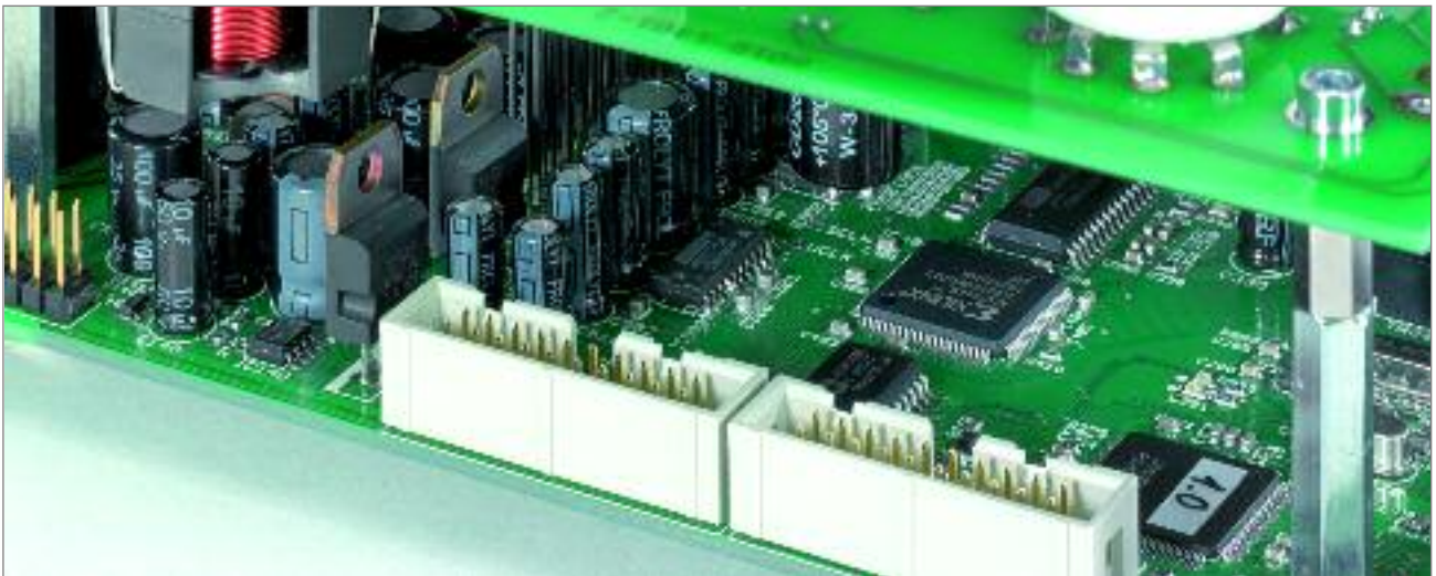
Der DigiMaster verlässt sich auf den nach wie vor erhältlichen PCM1704K
