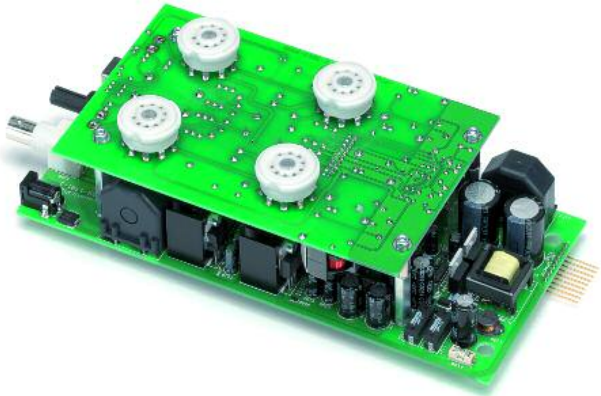
Wandlertrakt: dicht gedrängter Aufbau mit feinen Porzellan-Röhrenfassungen
