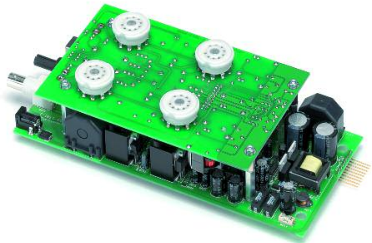
Wandlertrakt: dicht gedrängter Aufbau mit feinen Porzellan-Röhrenfassungen
