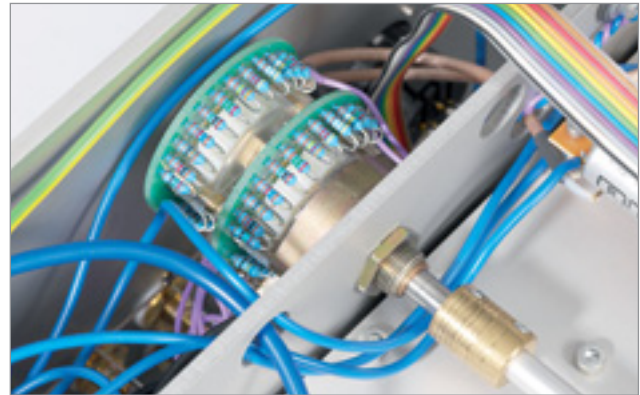
Pegelsteller aus dem Bilderbuch: Mithilfe von Einzelwiderständen ist jeweils nur ein Spannungsteiler im Signalweg
