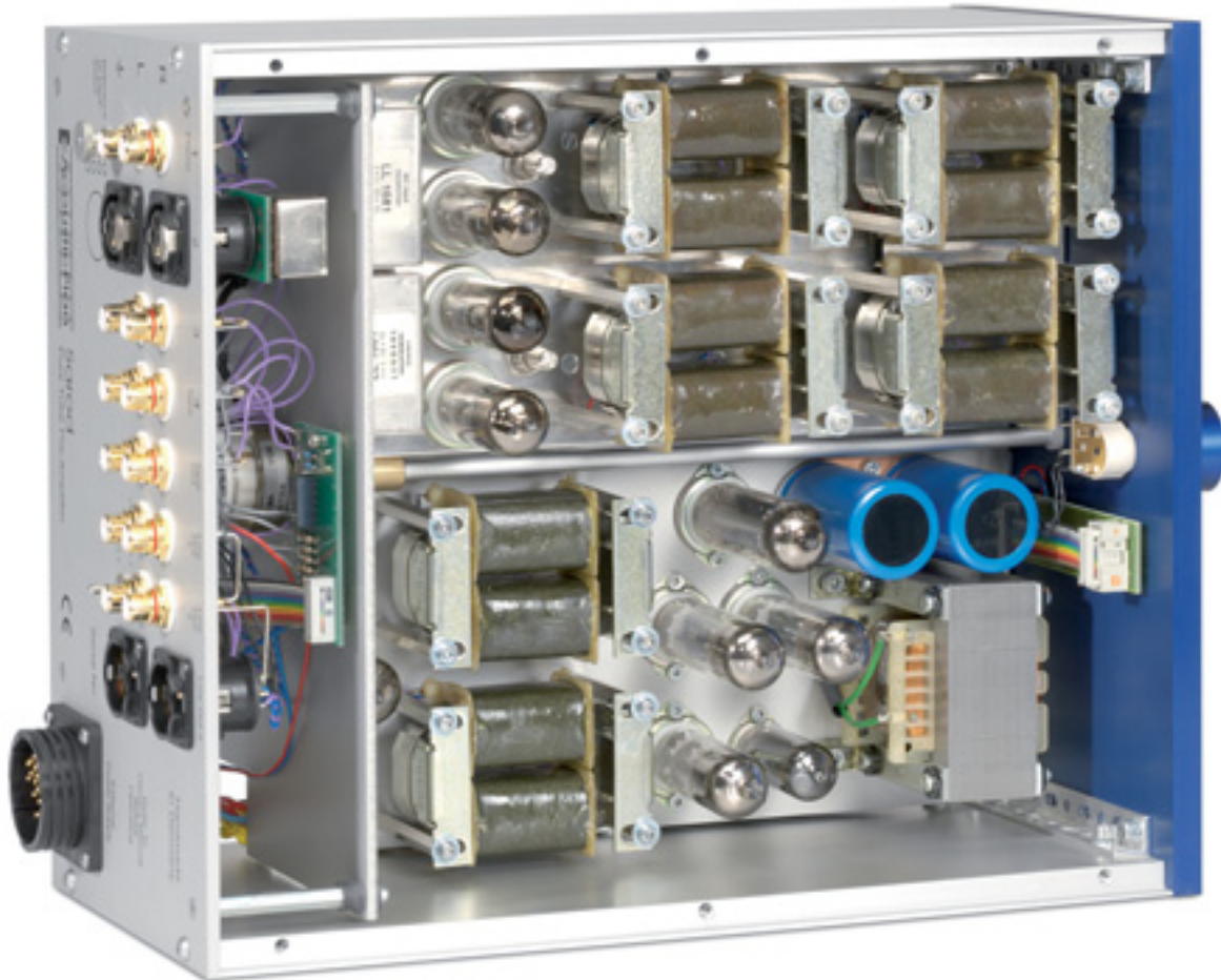
Vier professionelle Röhren – nach Postanforderungen gebaut – bilden die Phonostufe (obere Gehäusahälfte)
